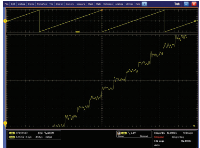
圖 21. 相同高解析度斜坡訊號的放大顯示，根據大量的平均值，並顯著高於垂直解析度。
